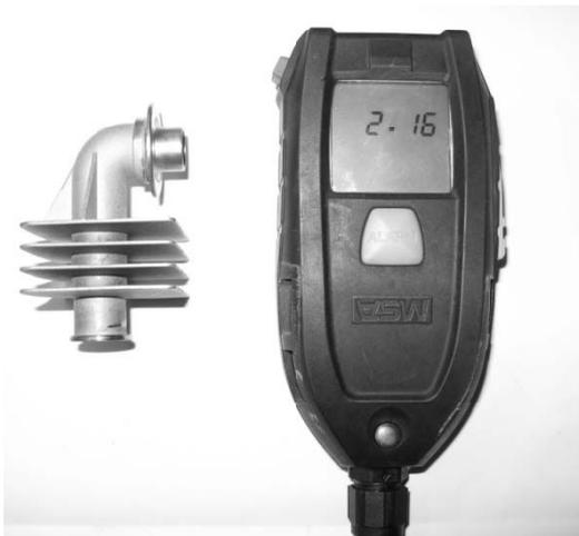
*Bild 2 Vorkühler neuer Bauart, Anzeige der IC-Air Softwareversion*
