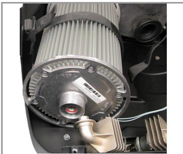
Bild 4 Einbau Kanister
